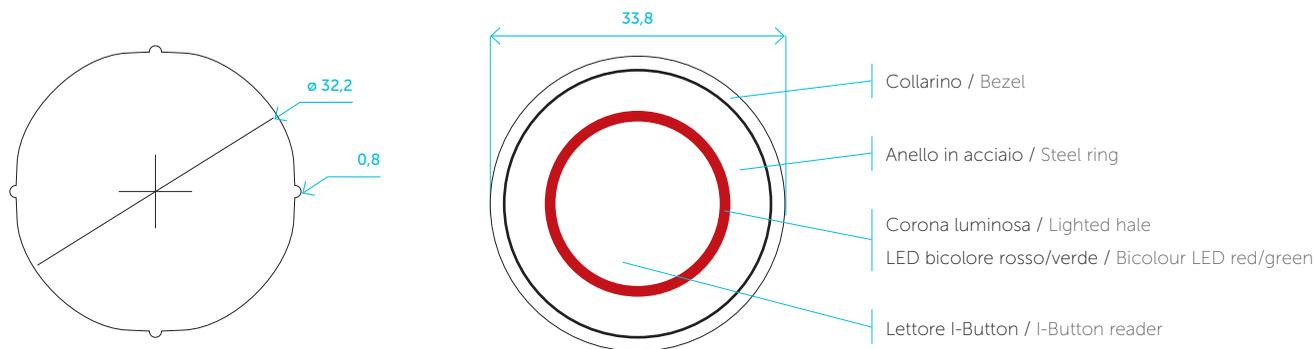
Contatto a chiave elettronico per abilitare l'utilizzo dell'ascensore solo a persone autorizzate, in condomini o ambienti professionali in cui è richiesto un particolare controllo sull'accesso. / Electronic Key-switch to enable the lift use only to authorized passengers, in apartment buildings or professional offices where a special access control is required.
