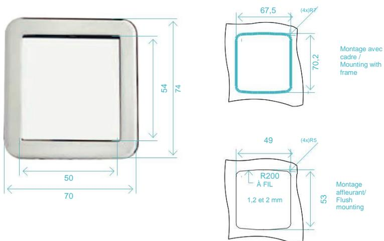
Encombrement de la carte montée derrière la plaque. / Display Encumbrance.
