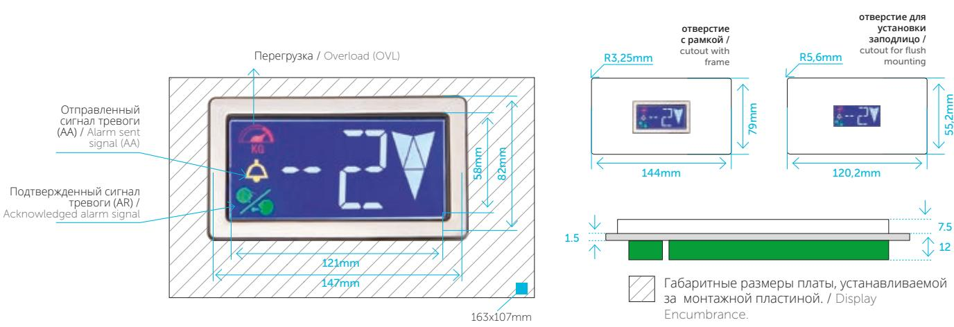
Габаритные размеры с кабелями / Encumbrance with wiring: 166x114mm
